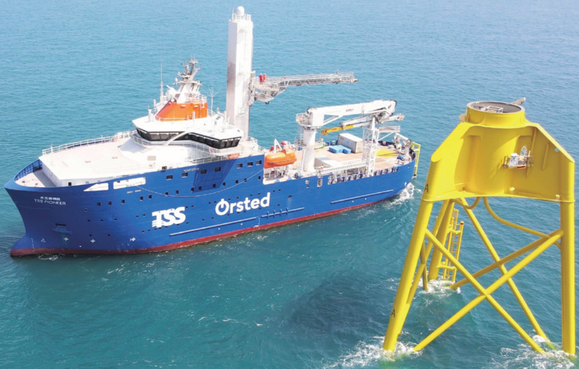
「大三商領航輪 TSS Pioneer」為全球首艘中華民國籍客製化離岸風電運維作業船（SOV），於 2022 年正式投入營運，為沃旭能源大彰化東南及西南第一階段離岸風場提供長期的運維服務。
