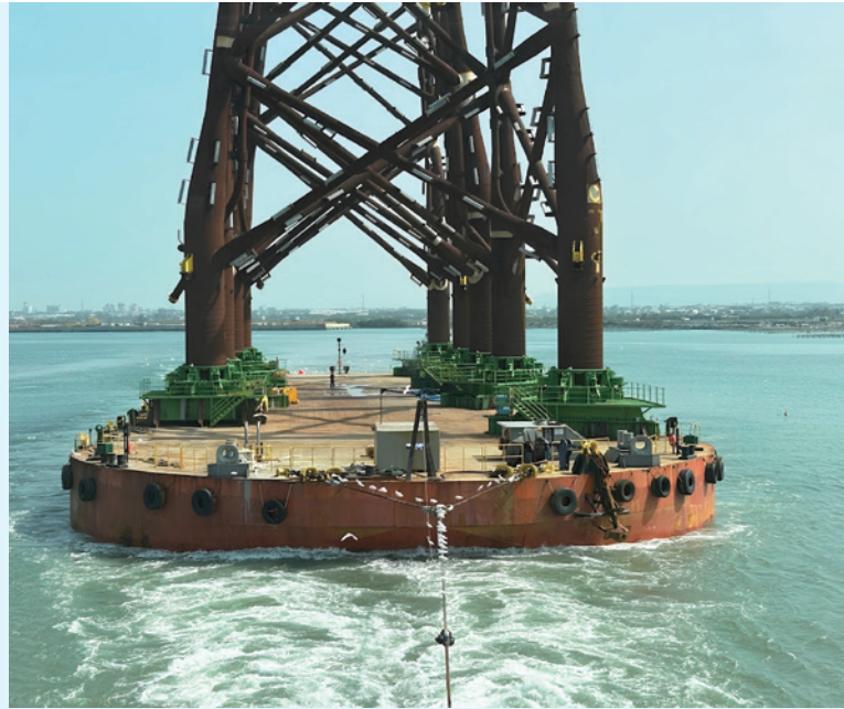
拖船與非自航式工作駁船以 Towing Bridle 緊密連結，進行拖帶作業。
