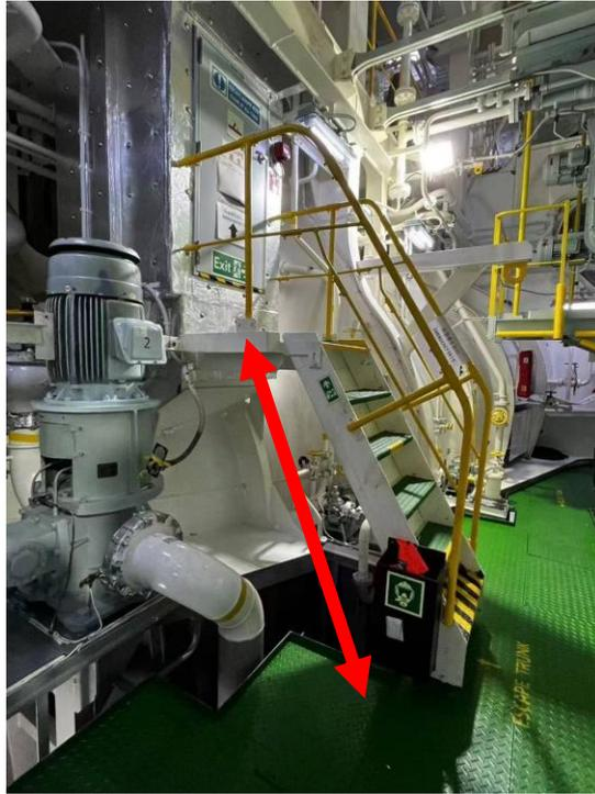
(圖7：逃生通道需藉由斜梯(紅箭頭處)連接機艙空間最底層甲板，可能被認定為不符合規定)
