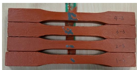
圖 6 局部腐蝕試片表面圖，將 pattern 外都以塗漆包覆
