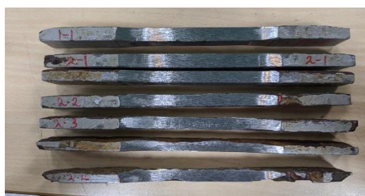
圖 9 均勻腐蝕後試片側視圖，由上至下為腐蝕程度逐漸加深，可看出在嚴重腐蝕(下方)，仍不能避免會使試片表面有些許起伏。
