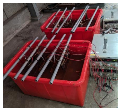
圖 7 定電流極化實驗架設置圖
