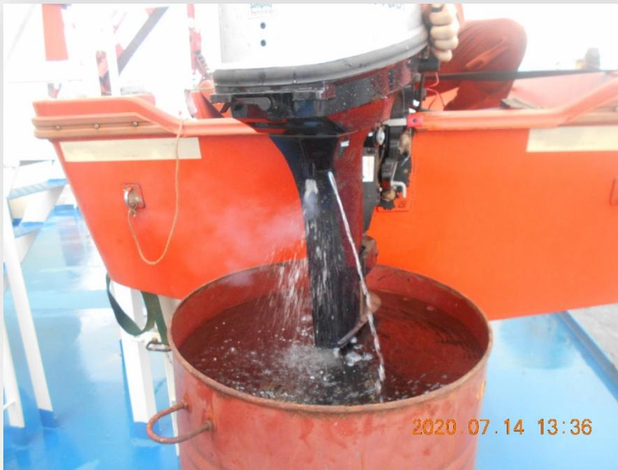
澳洲海事安全局(AMSA)在Marine Notice 12/2017通告中提及：檢查員發現到某些船員操作救難艇舷外機引擎時「未用冷卻水冷卻」或「未使用有效之方法冷卻」。此一情況會造成救難艇舷外機引擎損壞，因而導致船舶遭到PSC滯留。
