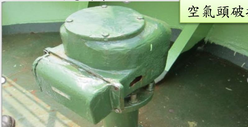
空氣頭破損及暫時性修補
