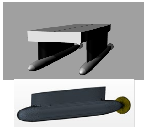
圖 2 SWATH 放置致動盤船體示意圖
