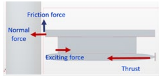
圖 1 頂靠風機塔柱時船體受力圖
