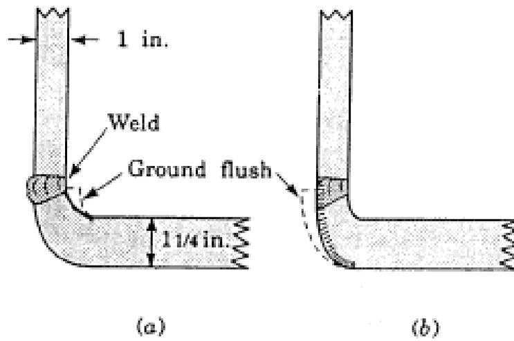
圖 19 — 銲接研磨平順處(Ground flush)會產生局部應力：(a)研磨處在槽內，因環境潮濕易生腐蝕；(b)若研磨處在槽外則較佳。
